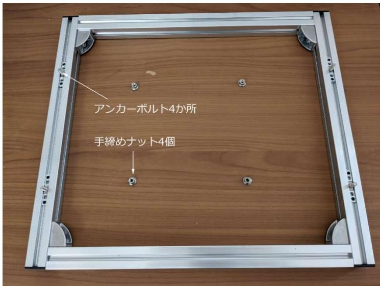
脚部のアンカーボルトを本体下部の L字金具の穴に通し、手締めナットで固定します。
