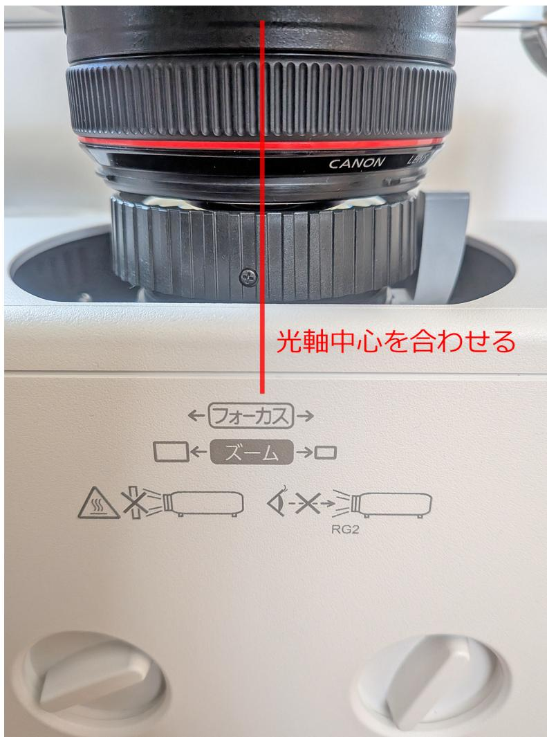
ドーム天頂（天井投影の場合は真上）に映像の中心が投影されるよう、プロジェクターのレンズシフト機能を使って東西方向と南北方向の投影位置を調整します。
