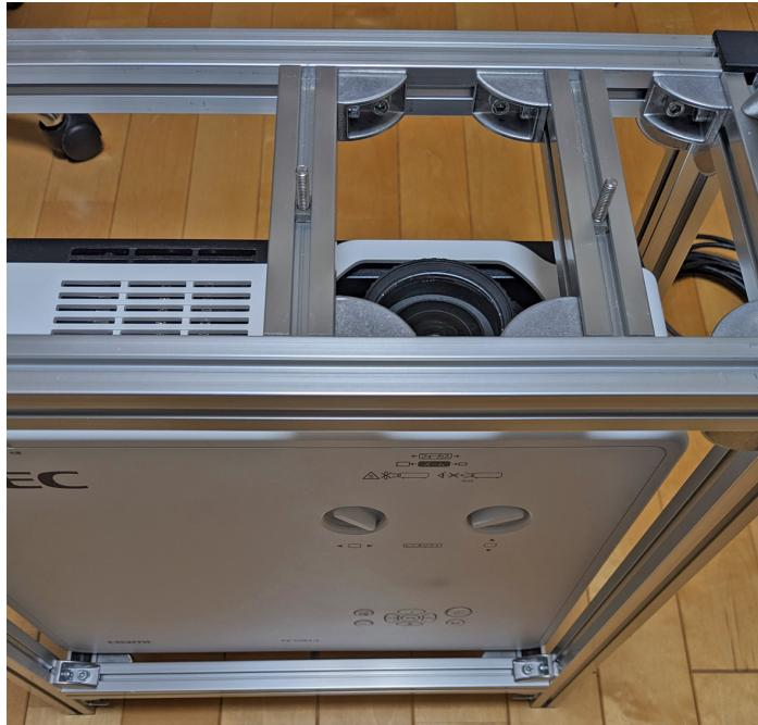
レンズユニットの集光レンズカバーを外し、ユニットのフランジ（円板）の穴にアンカーボルトを通して手締めナットで固定します。
